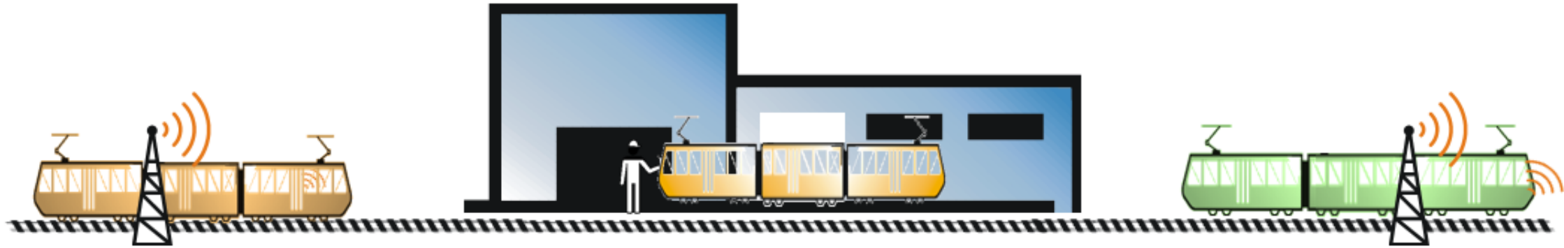
Depot Eingang mit RFID Leser
